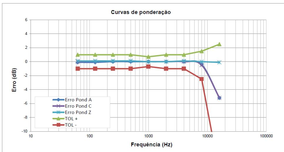
**Teste acústico (normalizado em 1000 Hz)**
